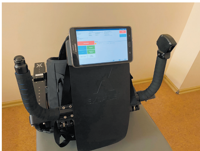
Рис. 2. Кнопка для остановки экзоскелета расположена на левой ручке для страховующего сотрудника. Кнопка включения питания расположена сбоку на спинке экзоскелета
