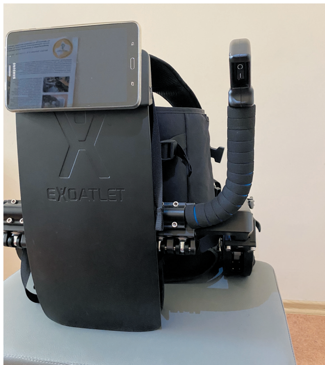
Рис. 3. Кнопка включения питания расположена на правой ручке для страхующего сотрудника
